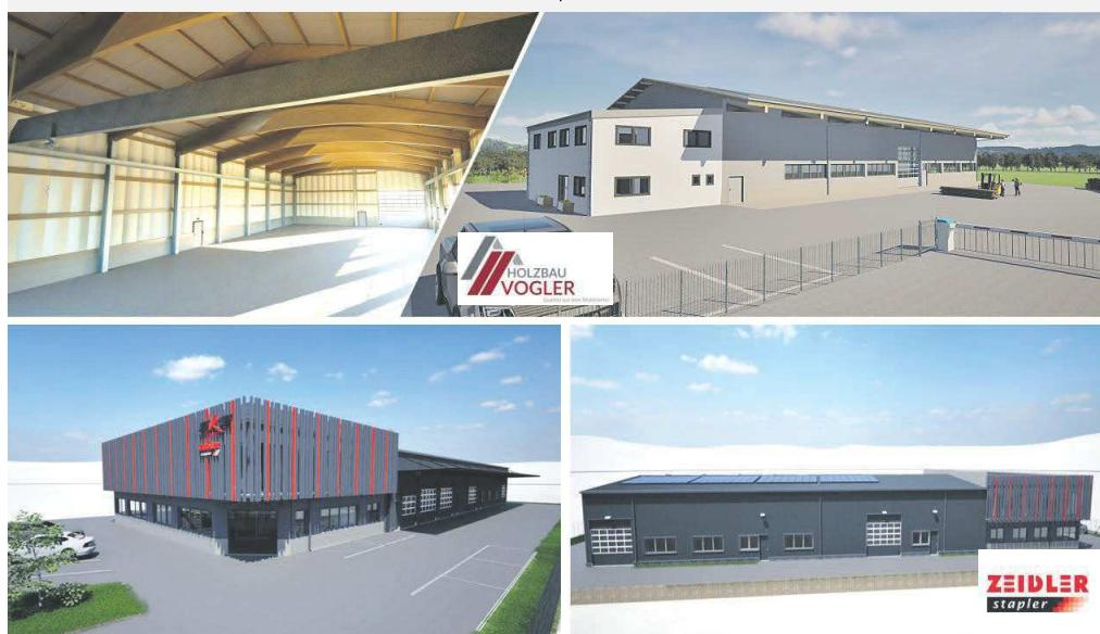
Derzeit befinden wir uns in der Planungsphase für den Neubau eines Betriebsgebäudes für die Holzbau Vogler GmbH in Weitra. Geplant ist eine Stahlkonstruktion mit den Abmessungen 20,00 m x 43,00 m, verkleidet mit Sandwichpaneelen. Wir wurden mit der Einreichplanung sowie der Visualisierung beauftragt und freuen uns, in Kürze mit der Umsetzung starten zu dürfen. Die HBH Electric Solutions GmbH, unser Fachbereich für Elektrotechnik, führt sämtliche Elektroinstallationen durch.
